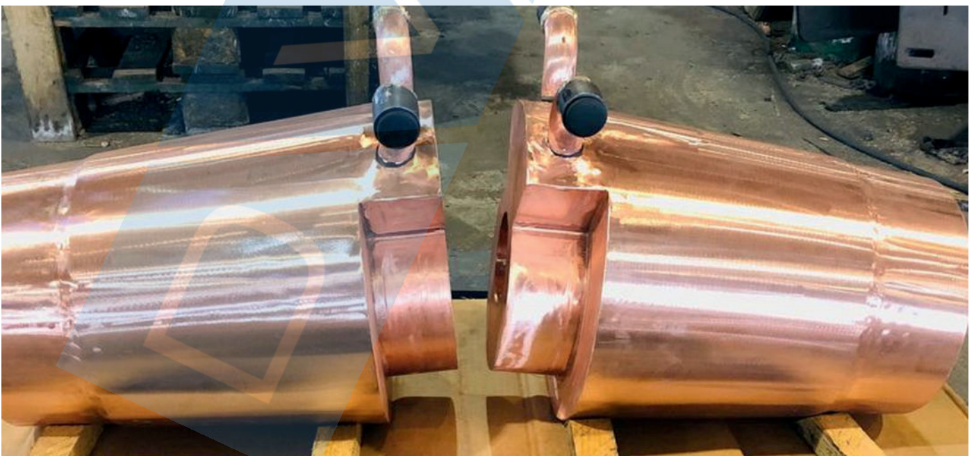
Gekühltes Abstichloch, hergestellt mit dem ionicLifecast-Verfahren (Bild: Mettop GmbH)
