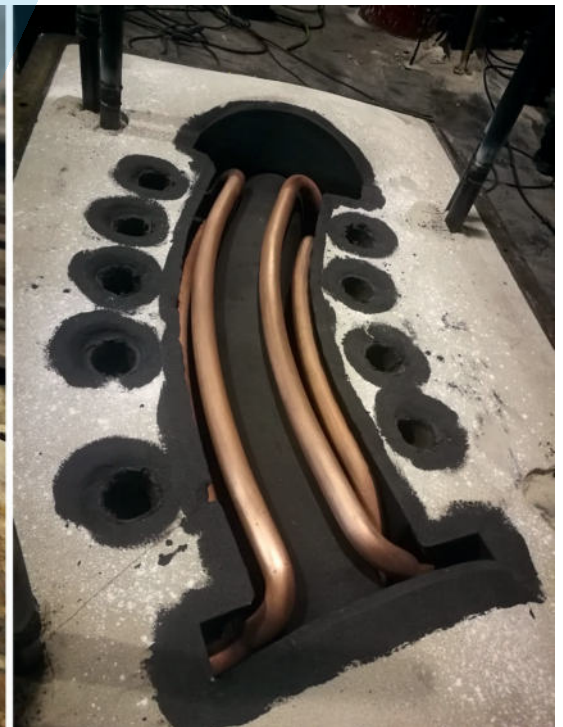
Kupferkühlelement mit eingegossenen Rohrschlangen und kombinierter Feuerfestzustellung (Bild: Mettop GmbH)
